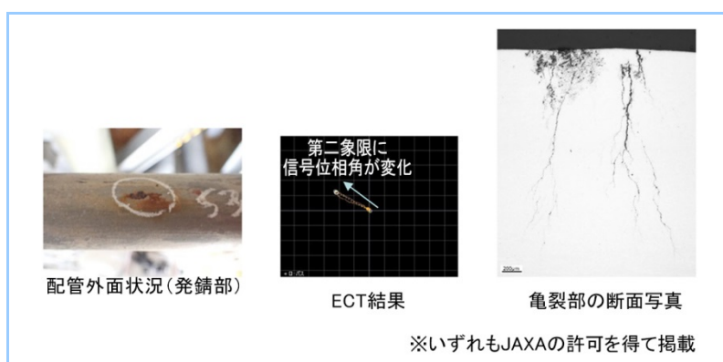
図10 ステンレス鋼配管外面における ECT 検査状況
