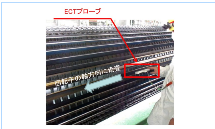
図6 実機回転子ダブテール部における ECT 検証試験状況
