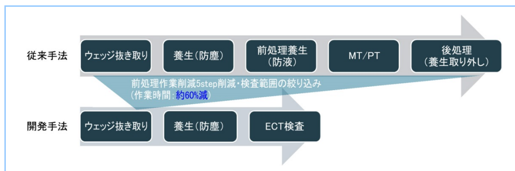
図8 従来手法と開発手法の検査フロー比較
