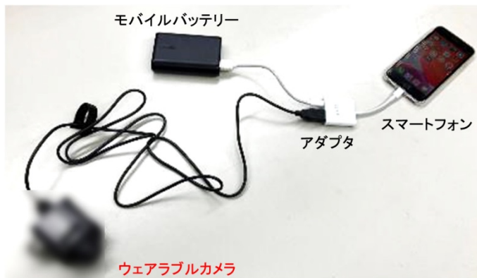
図2 遠隔作業支援ツールの構成
