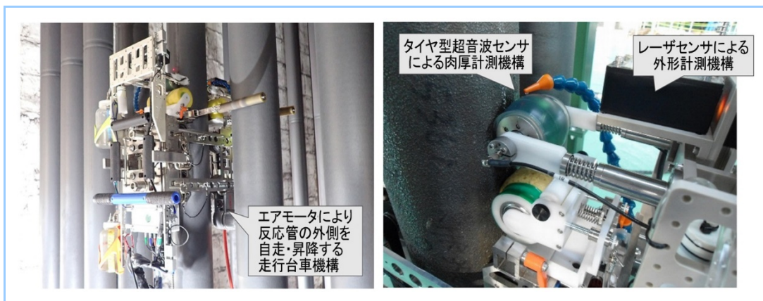
図2 リフォーマ反応管向け検査ロボット(RIDe)
