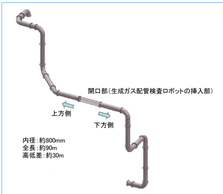
図 12 実機検証に用いた生成ガス配管
