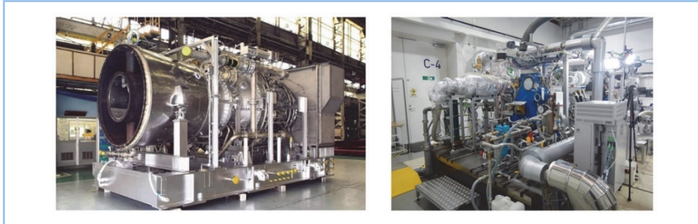
図3 水素・アンモニア焼きガスタービン(左)、及び水素ガスエンジン単気筒試験機(右)
