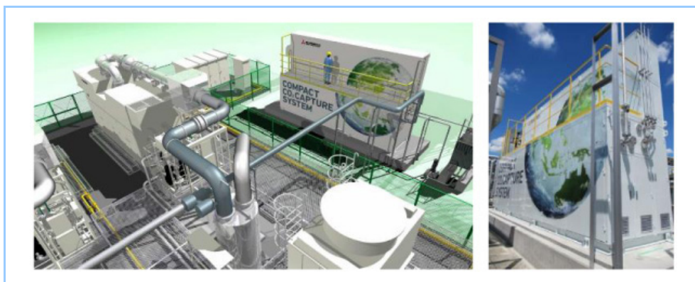
図8 GS16R2 1500kW 発電セットと小型CO 2 回収装置
