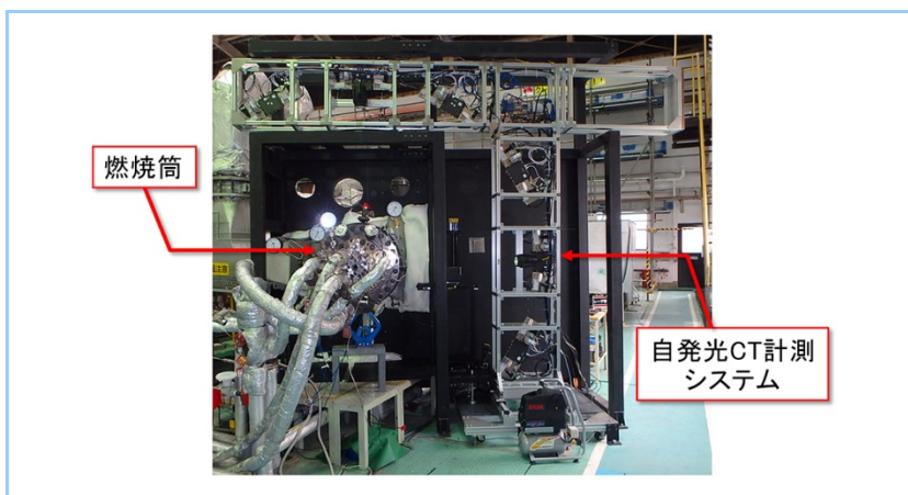
図7 自発光 CT 計測システムを組み込んだ当社の大気圧燃焼試験装置
