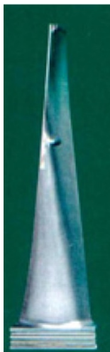
図1 蒸気タービン長翼の外観
