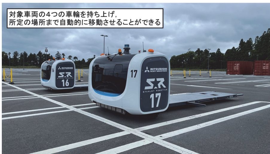
図6 SR社 自動車搬送AGVロボット“Stan”
