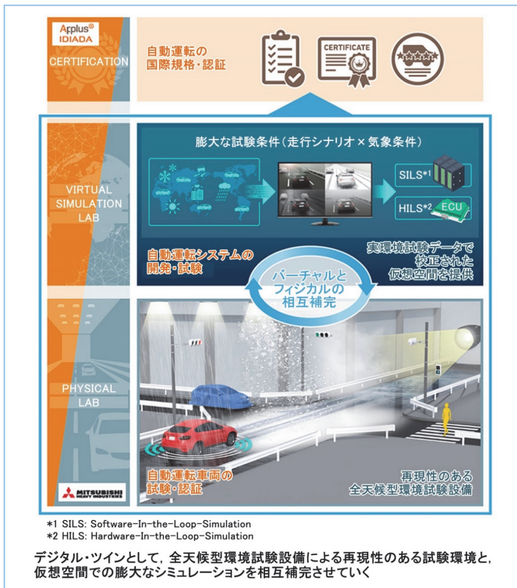
図2 高度自動運転車両の試験・検証システムと統合環境試験装置のコンセプト
