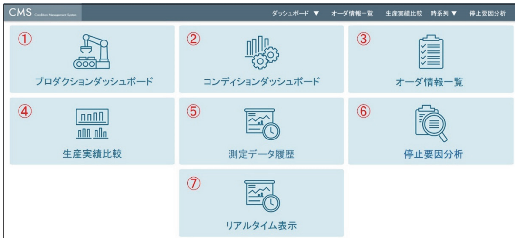
図2 納入機械遠隔監視
