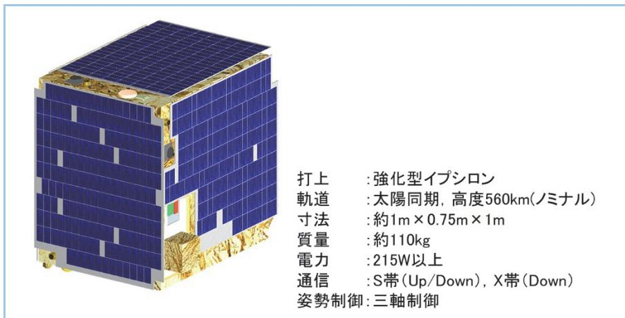
図1 小型実証衛星3号機 外観図・諸元
