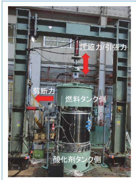
図 11 SLIM タンク静強度試験
