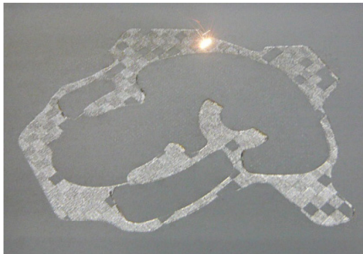
ターボチャージャ部品の積層造形中の写真
