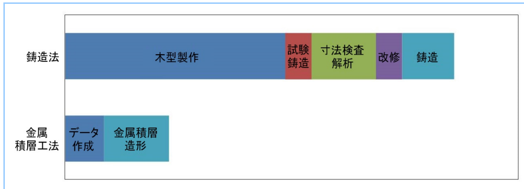
図7 鋳造法及び金属積層工法によりタービンハウジングを試作するプロセスのリードタイムの比較 各工程には標準的な待ち時間も含まれる。(機械加工および検査は、鋳造法と同じ工法のために省略)
