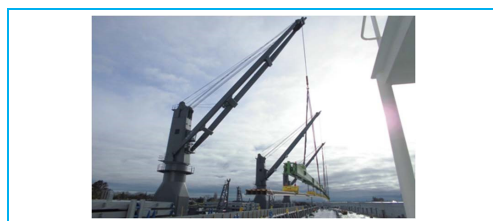
図3 長尺貨物用シンクロ制御デッキクレーン 3基のデッキクレーンの動作を同一かつ一斉に制御することにより、長尺貨物を一体で積み下ろしすることが可能
