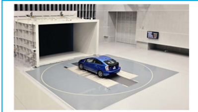
図4 実車空力低騒音風洞
