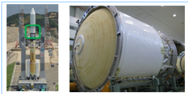
図6 \text{LH}_2 タンク白色塗装(H-IIA F21 号機)
