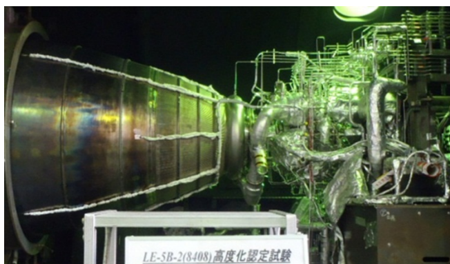
図10 2段エンジン高度化認定試験(60%スロットリング)
