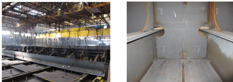
図2 溶接ロボット適用対象 スロット部の代表例
