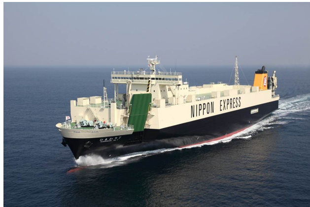
図4 復原力回復装置搭載 RoRo 船
