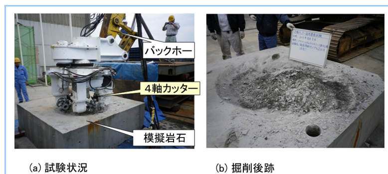
図3 4軸カッター掘削装置要素試験
