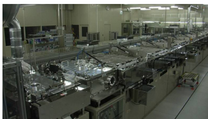
図5 インライン成膜装置の外観
