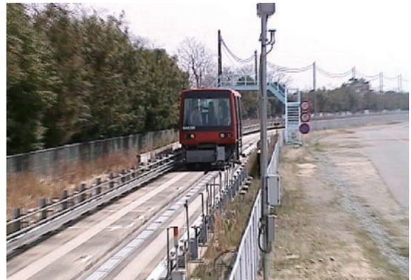
図4 APM のバッテリー駆動走行試験の様子
