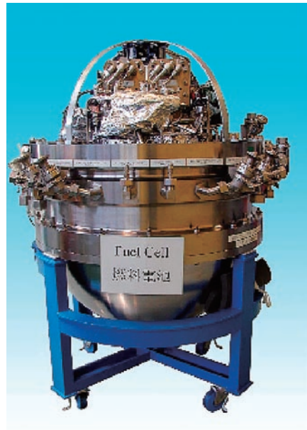
図7 「うらしま」搭載PEFC 水中閉鎖空間での使用のため4kW級の完全閉ループ式を採用。
