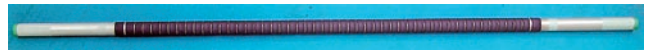
図 3 円筒形セルチューブ外観 直径 28 mm，長さ 1500 mm のセルチューブ。
