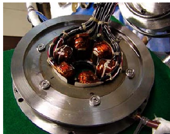
図5 ハイブリッドターボの試験状況及びモータステータ外観 エンジン試験中のハイブリッドターボ。モータステータは6スロット集中巻きで低損失小型化を図った。
