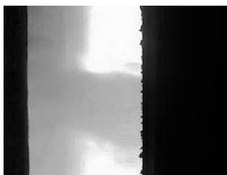
図6 110 MW発電負荷時のバーナ火炎 微粉炭 焚きと遜色ない輻射強度であり火炉内は火炎が充満している。
