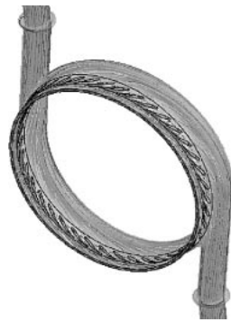
図5 蒸気入口部スクロール構造 蒸気通路のCFD解析結果を示す。
