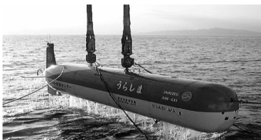
図1 無人巡航探査機“うらしま” 無人巡航探査機として世界最高記録更新となる317 kmの最長連続航行を達成（写真提供：（独）海洋研究開発機構）
