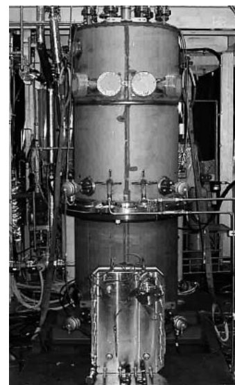
図3 一体型自然循環装置・水電解システム “高効率”“低コスト”を同時に克服する、発生H 2 /O 2 ガスのボイド率により水を循環させる自然循環型を採用。
