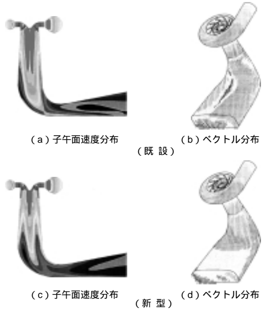
図7 速度分布及びベクトル予測結果 新型ランナによりドラフトチューブ壁面境界層が既設に比べ薄くなるようコントロールされている。
