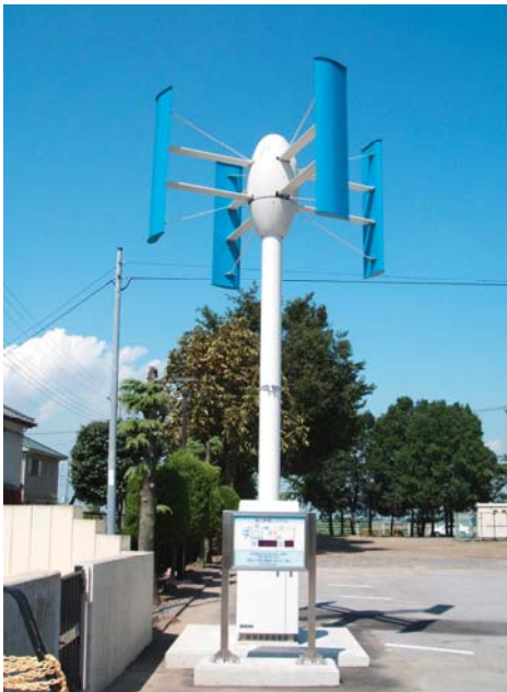
写真3 シンフォニアテクノロジーの「そよ風くん」 5) (定格出力 1.84kW、ロータ径 3.2m×翼高さ 2m、垂直軸風車)
