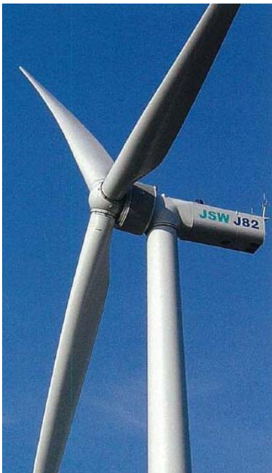
写真8 日本製鋼所のギアレス同期風車「J82」 10) （定格出力 2000kW、ロータ径 82m、ギアレス PMSG）
