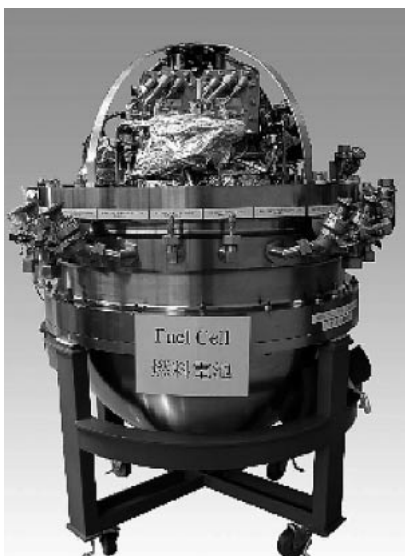
図2 “うらしま”搭載PEFC 水の中閉鎖空間での使用のため4 kW級の完全閉ループ式を採用。
