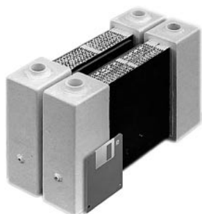
図8 MOLB形SOFCスタック 発電膜, インターコネクタ, ガスシール材, 及びマニホールドよりなるサイズ 200 mm の発電スタック.
