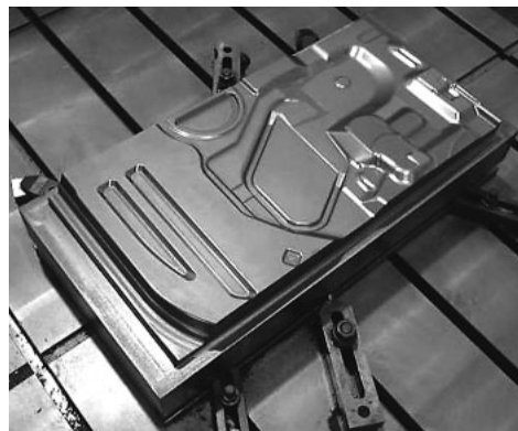
図5 インナー金型加工例 自動車内側部品の金型加工例で複雑な形状加工を示す。
