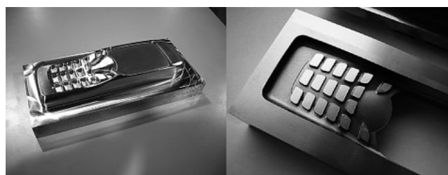
図7 携帯電話銅電極と放電加工後加工面
