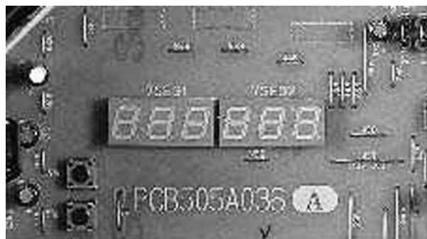
図7 室外コントローラ7セグ表示 ユニットの温度・圧力・制御状況等のデータを室外機コントローラの7セグ表示で確認できるようにし、試運転・サービス性を向上した。
