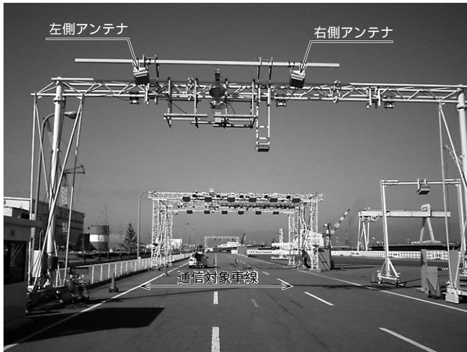
図4 フィールドテスト風景 当社二見工場ITSテストコースで実施したフリーフローETCシステム用アンテナの通信領域測定風景。
